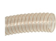
PHHH Polyuretanlange. Antistatisk. T= 1.4 mm. Temp. -40 til +100 C. L= 5 - 10 mtr.
