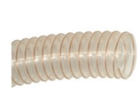
PUHH Polyuretanlange. Antistatisk. T= 0.7 mm. Temp. -40 til +100 C. L= 2.5 - 5 - 10 mtr.
