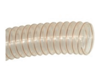
PUCH - CNC Polyuretanlange. Antistatisk. T= 0.6 mm. Temp. -40 til +100 C. L= 5 - 10 mtr.
