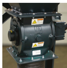
Rotorsluse for automatisk utmatning til container/bibag.
