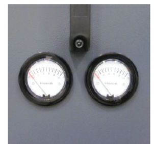
Differansetrykkfall over filtre For enkel overvåking av tilsnugging av filtre kan Minihelic-differansetrykksmanometre bygges inn i frontluken på OUK (antall avhenger av størrelse).
