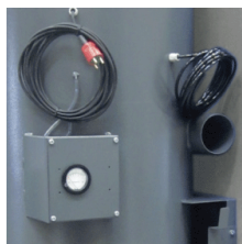
Enkel tilkobling 230V elkabel med stikk og Ø8 mm trykkluftslange finnes på front av anlegg.
