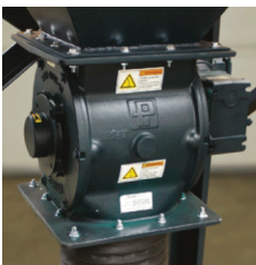
Rotorsluse for automatisk utmating til container/bibag.
