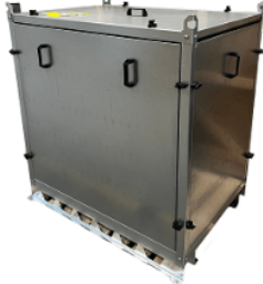
SHPV Sentrifugalvifte Stillegående og pålitelig remdrevet høytrykk radial- vifte i lydkabinett.
