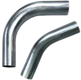
STBE Bend Elforsinket. Forlengede stusser. ø38–203 mm. 45 og 90°. R= 75–305 mm.
