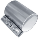
PICO-LONG-HD Rørkobling Galvanisert med NBR pakning og rustfri jordlisse. Lengde 150 mm. ø102–203 mm.
