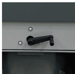
Manuell eller automatisk rensing av filter Roto-rens aktiveres ved å dreie 5–10 ganger på det utvendige håndtaket eller via gearmotor og styringsautomatikk.
