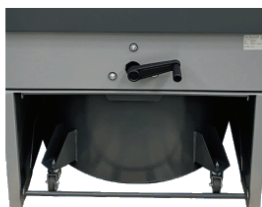
Støvbeholder Quicklock-justerbar støvbeholder (72/150 L) på 4 dreibare hjul sikrer brukervennlig håndtering av støvbeholderen.
