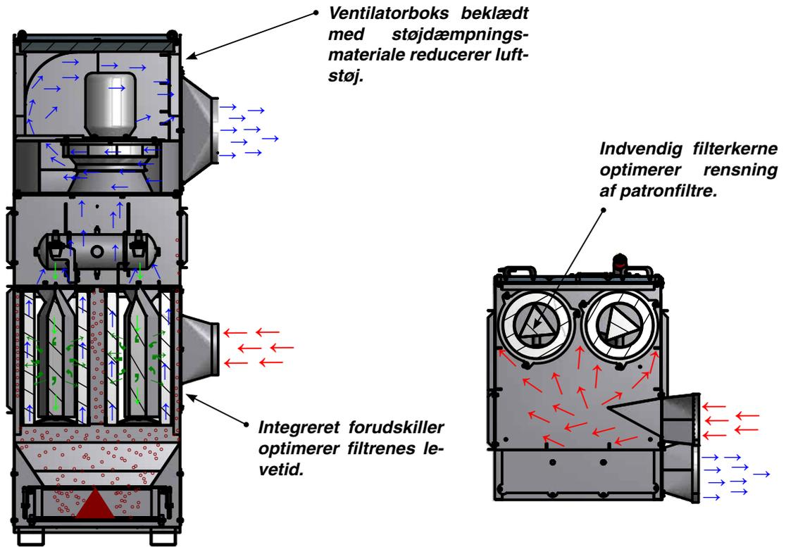
Principskitse for flow gennem Filterline type FL uden indbygget ventilator:
