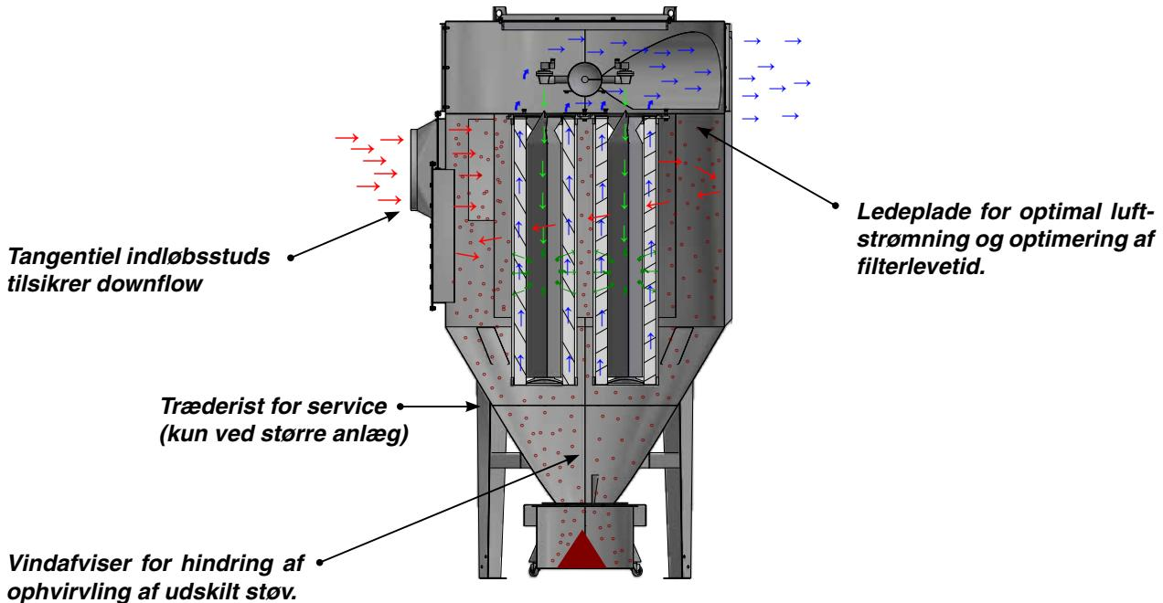
Principskitse for flow for cyklonfilter type ACF-T-A / -T-V-A / -T-A-HO:
