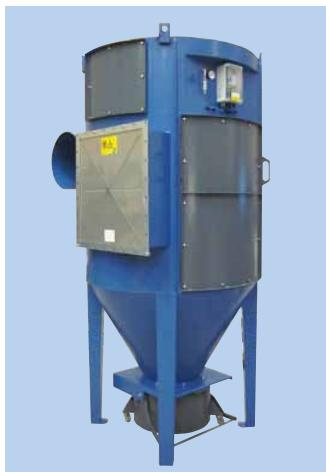
Energioptimeret anlæg til større filtreringsopgaver, hvor der er risiko for støveks-plosioner, f.eks. ved filtrering af aluminiumsstøv, træstøv eller støv fra håndtering af diverse pulvermix. Anlæg konstrueret for anvendelse ved ATEX-zonerne 21-22 og standard forsynet med en aflastningsmembran, beregnet til at bryde ved en eksplision, hvorved anlæg aflastes og eksplisioner kontrolleres.
