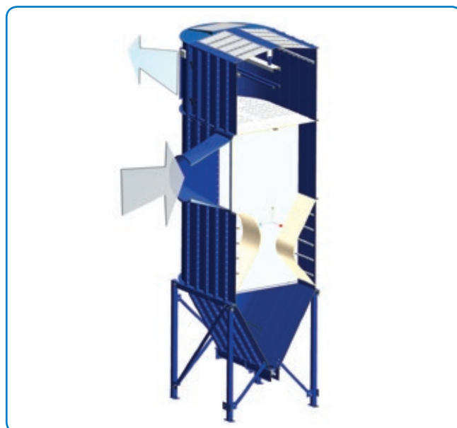
SBF-filter med keglebund og sideindløb. Snittet viser Coandapladerne, som accelererer og fortætter partiklerne, så de falder ned i filterbunden.
