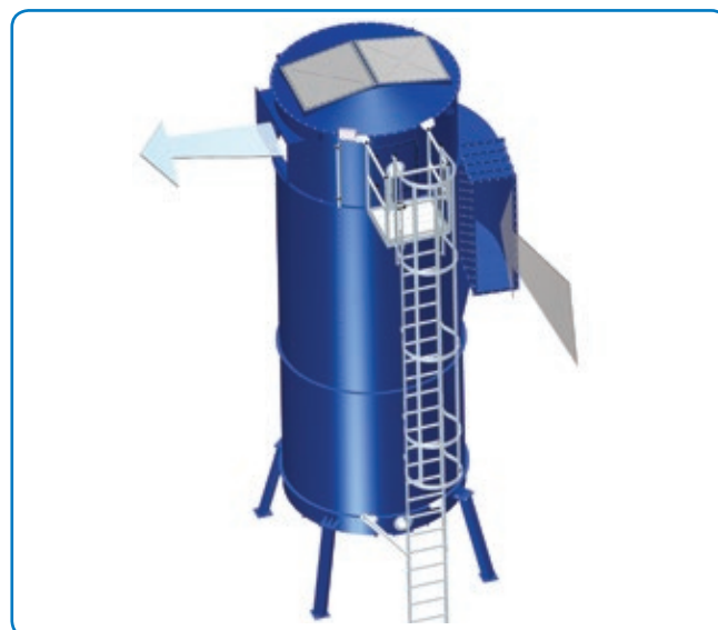
BF-filter med skræbebund og tangentielt indløb. Vist med VFV®-eksplosionsafledning i filtertoppen. Monteret med stige og platform.
