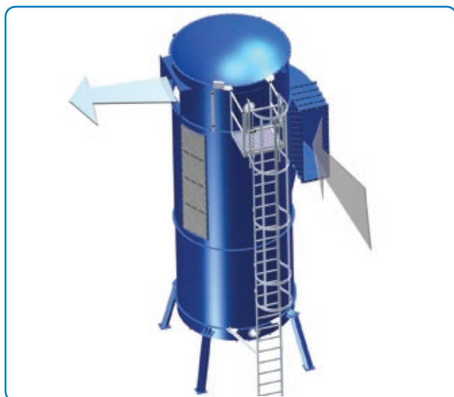
BF-filter med skræbebund og tangentielt indløb. Vist med eksplosionsafledning i siden. Monteret med stige og platform.
