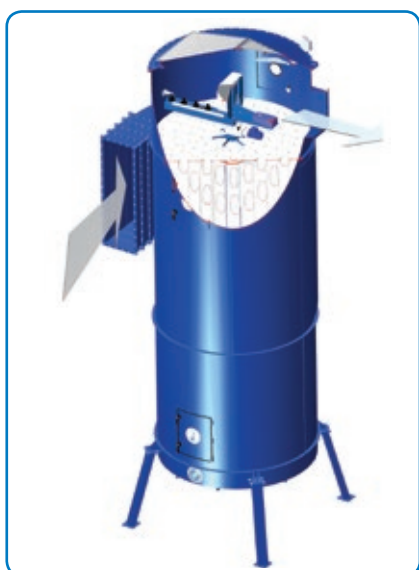
Blower-filter med skrabebund og tangentieltindløb. Snittet viser PowerPulse®-rensesystemet.
